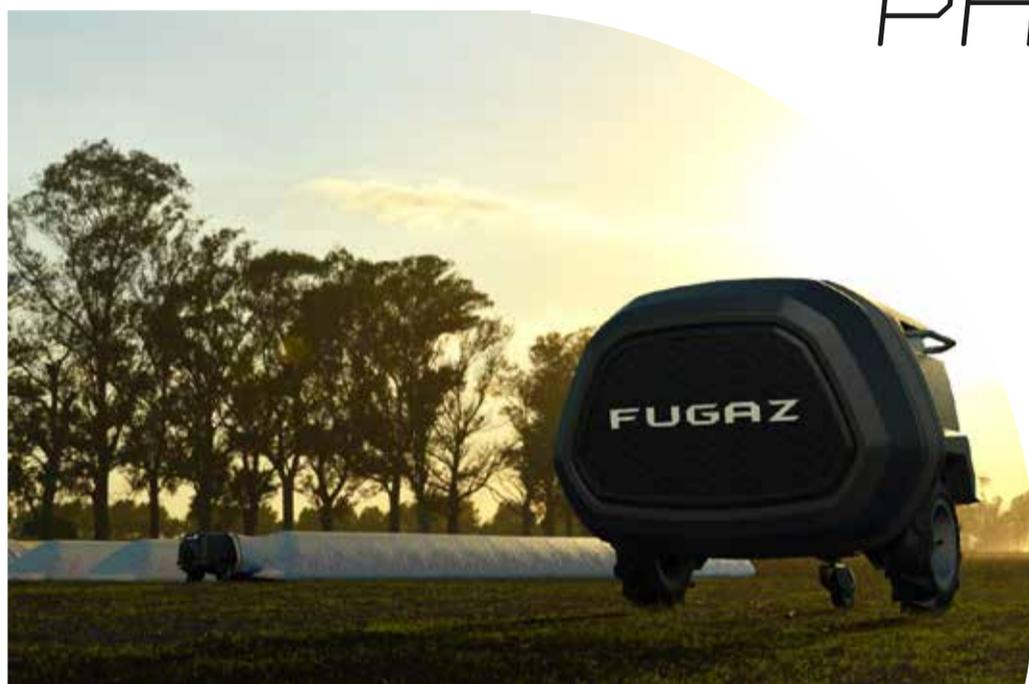
**TMJ Fugaz es un mecanismo que permite la aireación de granos almacenados en silobolsa y brinda al productor la posibilidad de “reducir el porcentaje de humedad” para “garantizar” la calidad de la producción. El proyecto fue realizado por estudiantes de Diseño Industrial, que se dicta en el CRES San Francisco, para rendir su Trabajo Final de Grado.**
